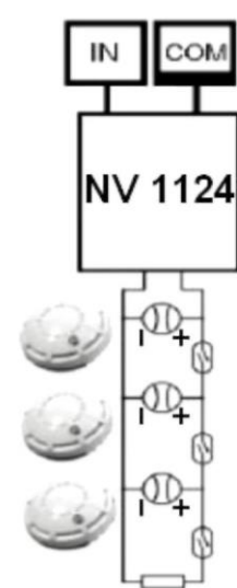
шлейф пожарных двухпроводных извещателей
